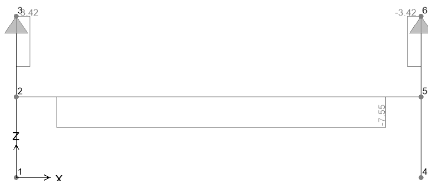
Figura 6.12. Trasverso di campata – Sforzo normale SLU
