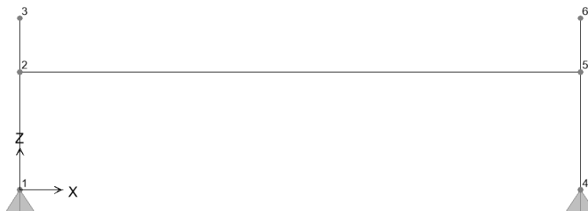
Figura 6.14. Modello di calcolo - Trasverso di appoggio – spalla
