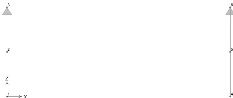
Figura 6.10. Modello di calcolo - Trasverso di campata DI
